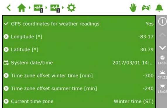
Figure 2-5: Le paramètre 'Coordonnées GPS pour la météo' est activé
